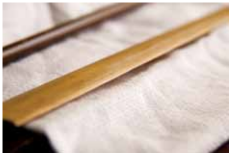
手前が金箔を切るための竹刀。竹刀づくりが重要なポイント。
