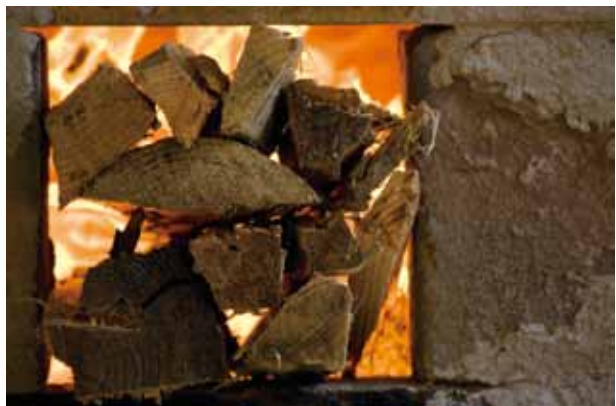
800度近くになると、窯の入り口を、薪で蓋をし(木蓋)、より温度をあげていく。
